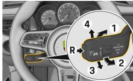
Fig. 176 : Levier de commande du régulateur de vitesse adaptatif (ACC)
