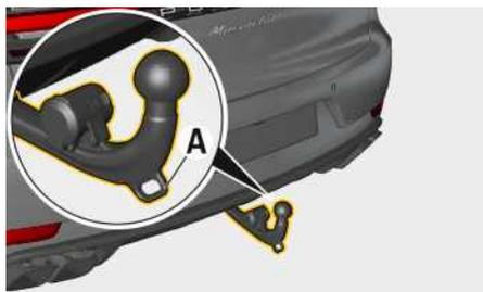
Fig. 97 : Accrochage du câble de retenue dans l'œillet de fixation
