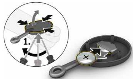
Fig. 160 : Remplacement de la pile de la clé d'ouverture à distance PVTS Plus
