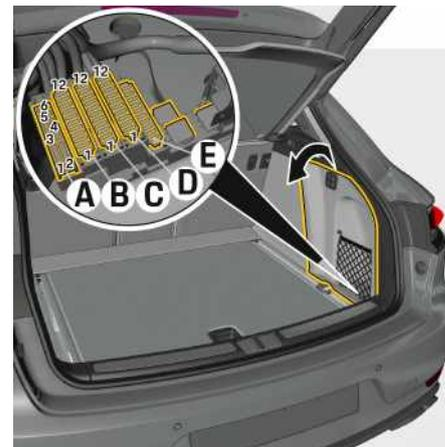
Fig. 115 : Boîtes à fusibles du coffre à bagages
