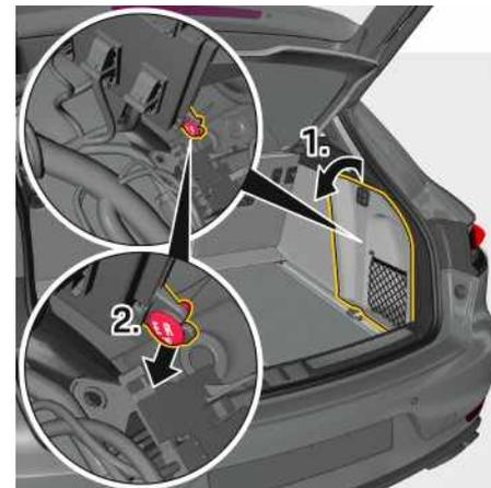
Fig. 172 : Déverrouillage d'urgence de la trappe du réservoir
