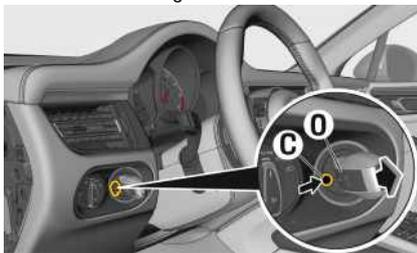
Fig. 46 : Procédure de déverrouillage d'urgence
