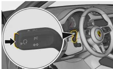
Fig. 87 : Touche de commande vocale sur le levier de commande
