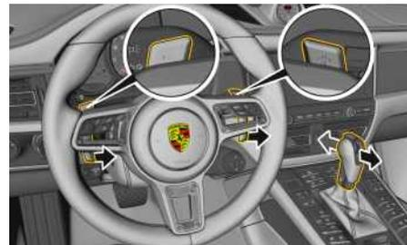
Fig. 26 : Volant avec palettes de passage de rapport
