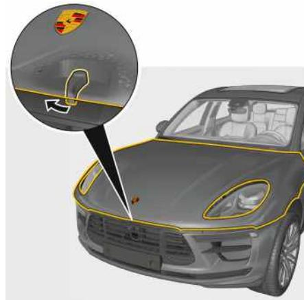
Fig. 30 : Ouverture du capot moteur
