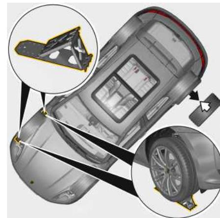
Fig. 91 : Positionnement des cales
