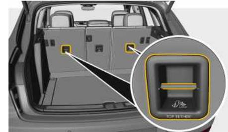
Fig. 220 : Points de fixation du point d'ancrage (Top Tether)
