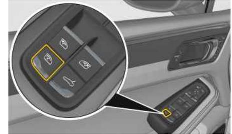
Fig. 197 : Désactivation des touches de commande dans la partie arrière
