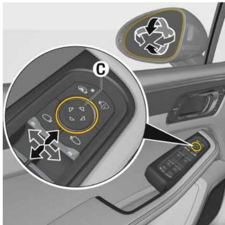
Fig. 187 : Réglage des rétroviseurs extérieurs
