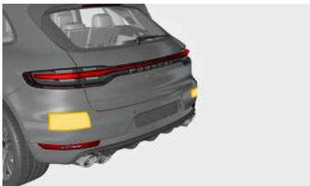
Fig. 6 : Capteurs radar dans le pare-chocs arrière
