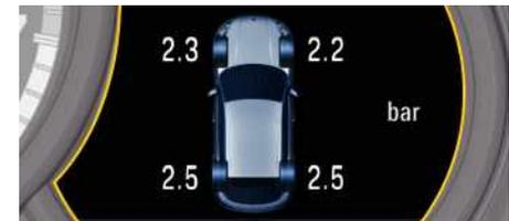
Une pression trop faible ou trop élevée détériore le pneu et la roue, augmente considérablement la distance de freinage et le risque d'accident. En cas de pression insuffisante, la consommation de carburant peut augmenter sensiblement.
