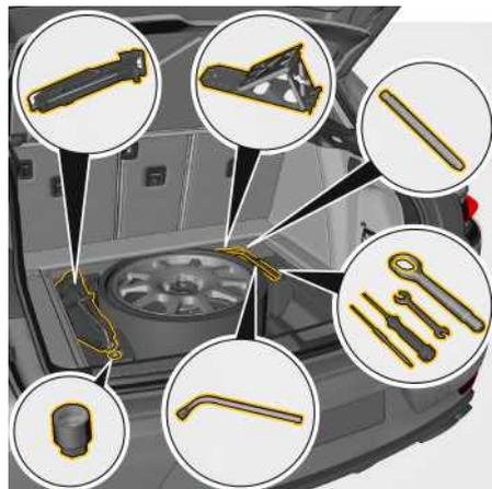
Fig. 63 : Outillage de bord dans des véhicules avec roue de secours de type galette
