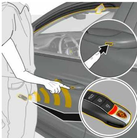
Fig. 238 : Fermeture des vitres à l'aide du détecteur de proximité intégré à la poignée de porte
