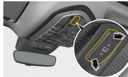
Fig. 201 : Ouverture et fermeture du store de protection solaire
