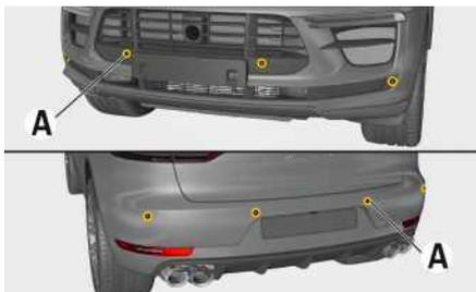
Fig. 12 : Capteurs à ultrasons utilisés pour la mesure de la distance
