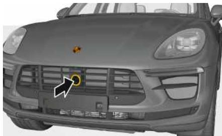
Fig. 175 : Position du capteur radar
