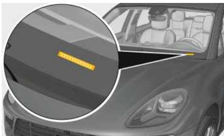
Fig. 244 : Emplacement du numéro d'identification du véhicule
