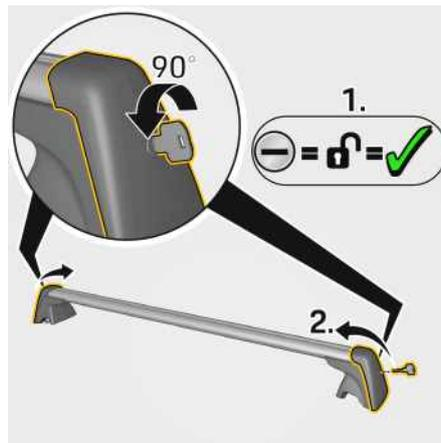
Fig. 204 : Ouverture des pieds d'appui
