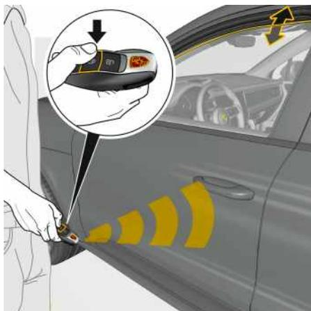
Fig. 237 : Ouverture et fermeture des vitres avec la clé du véhicule
