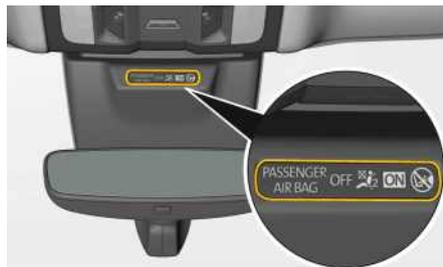
Fig. 217 : Indicateur PASSENGER AIR BAG OFF/ON
