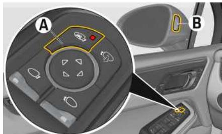
Fig. 5 : Touche A d'activation et de désactivation, affichage B dans le rétroviseur extérieur
