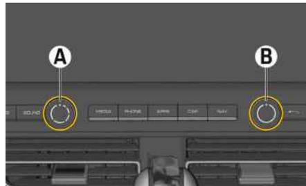
Fig. 143 : Bouton rotatif de réglage et bouton de réglage du volume PCM
